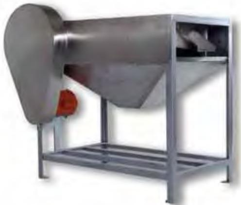
Ofrece un cribado uniforme y fino, perfecto para la producción de diferentes tipos de harinas. Cumple con los requerimientos de materiales en grado alimenticio.
