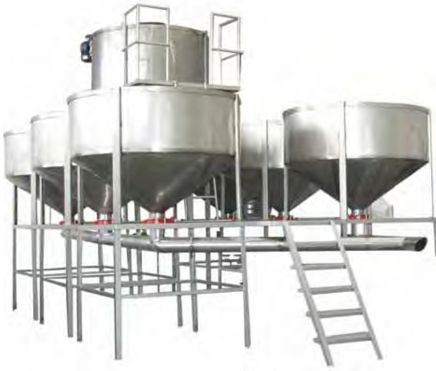
Incluye: revoladora, pailas, base para pailas, compuertas, pasillos, barandales, tubos de descargue, cuadrados de descargue, bridas, escalerilla, escalera marina, bazuca con silo para maíz, bazuca-lavador de nixtamal, calentador, base para calentador, chimenea, termometro, quemador tipo araña atmosférico, niveladores, compuertas, motores y poleas.
